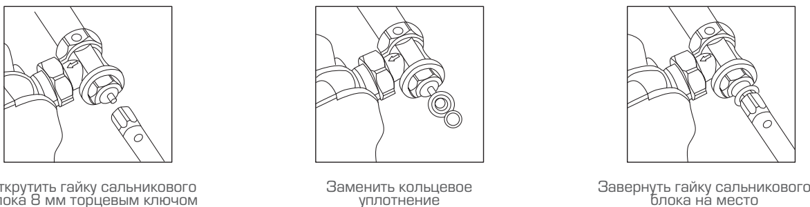
Рис. 21. Замена кольцевого уплотнения штока клапана терморегулятора
