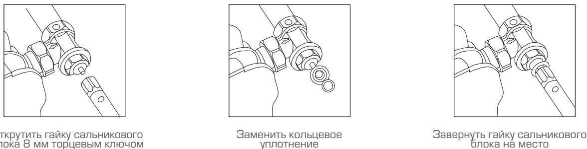
Рис. 21. Замена кольцевого уплотнения штока клапана терморегулятора
