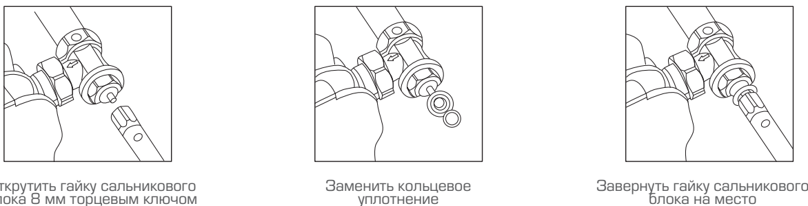
Рис. 21. Замена кольцевого уплотнения штока клапана терморегулятора
