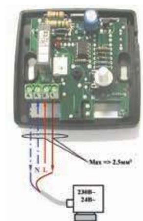
Рис. 13. Схемы электрических соединений термостата
