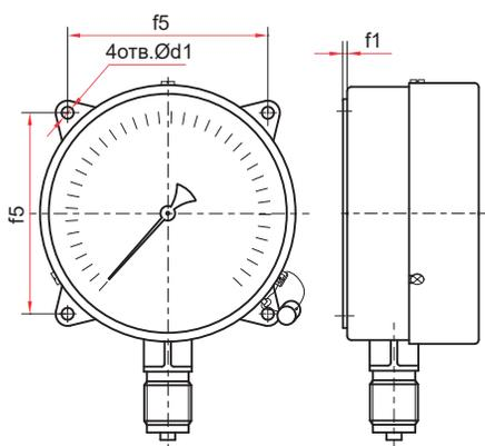
Радиальное присоединение с задним фланцем (Ø100, 150, 160 мм)
