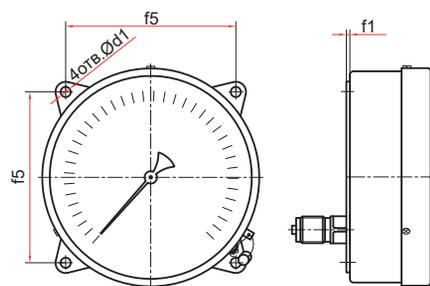
Эксцентрическое присоединение с задним фланцем (Ø150, 160 мм)
