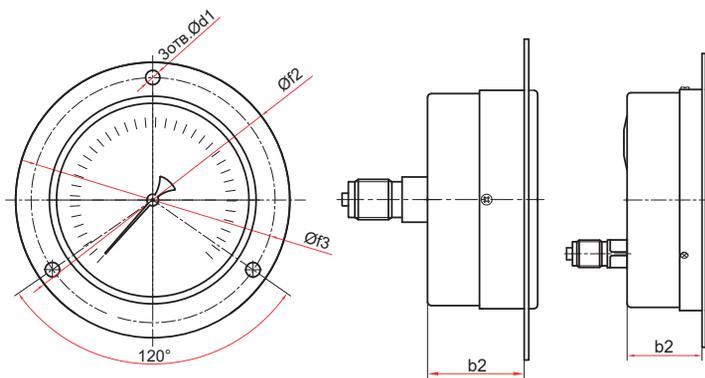
Осевое присоединение с передним фланцем (Ø63 мм)
