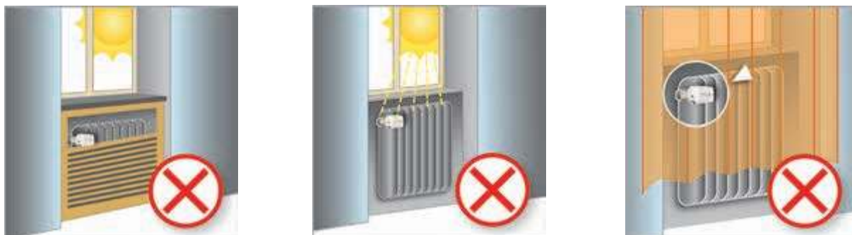
Рис. 8. Требования по размещению автоматического терморегулятора
