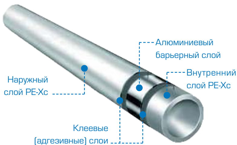
Рис. 2. Пятислойная труба PE-Xc/Al/PE-Xc
