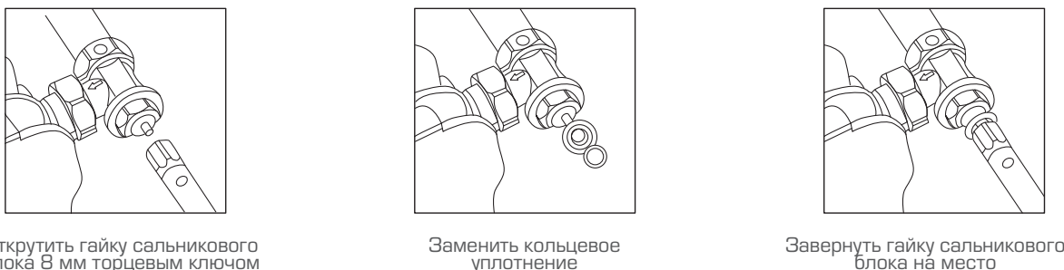
Рис. 21. Замена кольцевого уплотнения штока клапана терморегулятора
