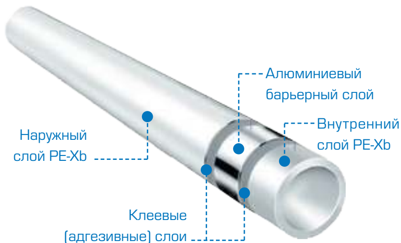
Рис. 5. Пятислойная металлополимерная труба PE-Xb/Al/PE-Xb
