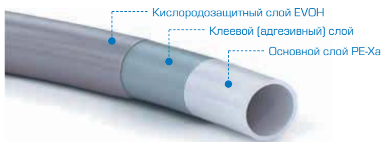
Рис. 1. Трехслойная труба РЕ-Ха/EVONH
