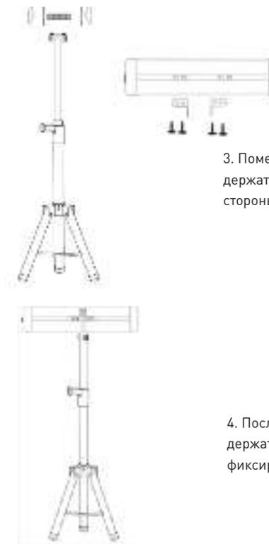
3. Поместите нагреватель, установленный на неподвижном держателе, в неподвижную ось в соответствии с п.2, и обе стороны зафиксируйте с помощью расположенной ручки.
