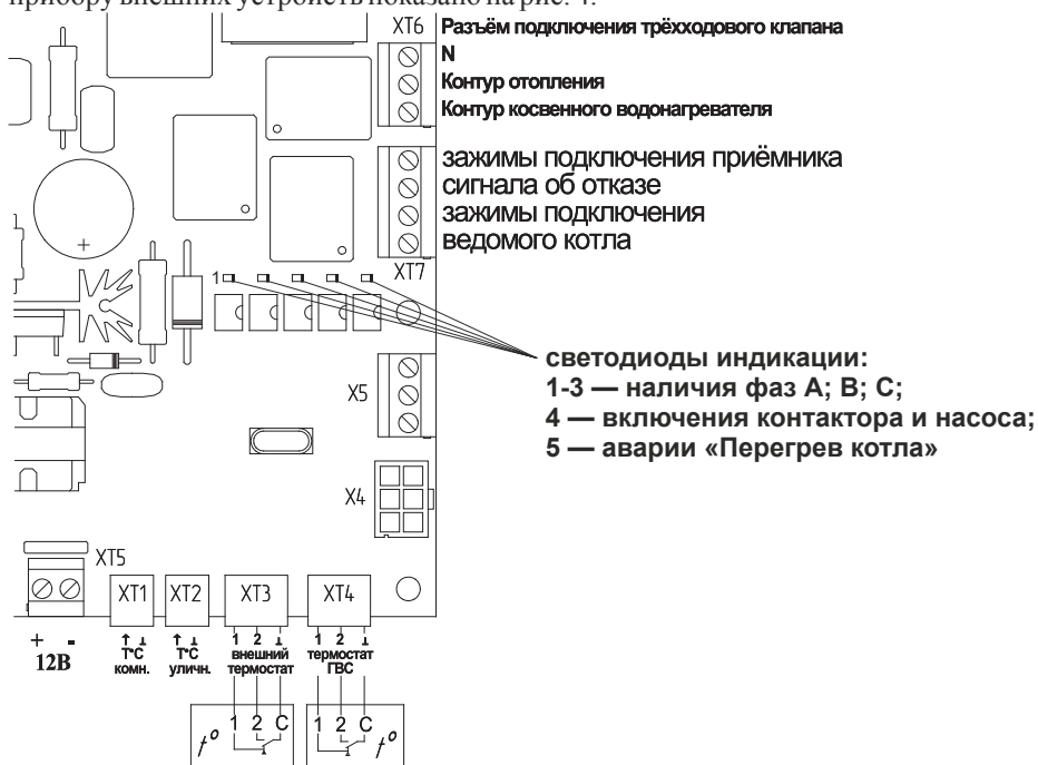
Рисунок 4. Расположение на плате управления разъёмов для подключения внешних устройств.
