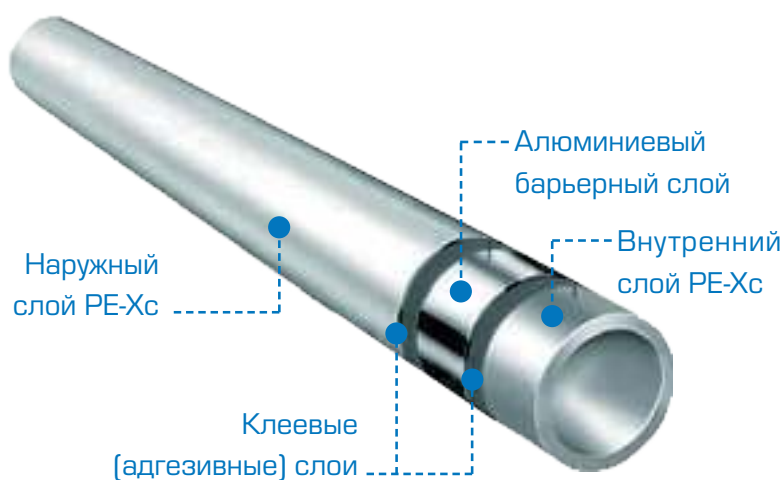
Рис. 2. Пятислойная труба PE-Xc/Al/PE-Xc
