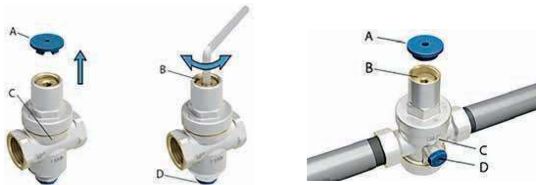
Рис. 22. Монтаж редуктора
