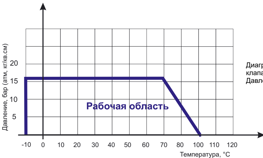
Диаграмма Давление / Температура для клапана обратного ABRA-D-022-NBR
