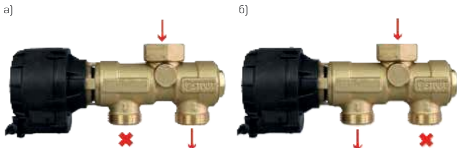
Рис. 14. Принцип действия трехходового клапана
