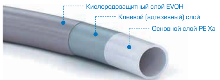
Рис. 1. Трехслойная труба РЕ-Ха/EVONH
