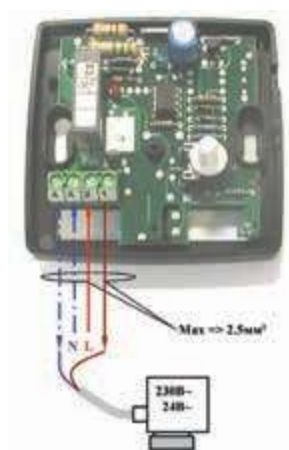
Рис. 13. Схемы электрических соединений термостата
