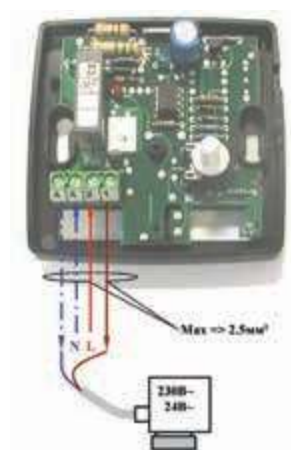
Рис. 13. Схемы электрических соединений термостата
