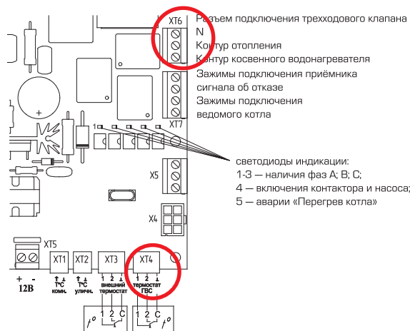
Рис. 13. Схема подключения датчика температуры бойлера
