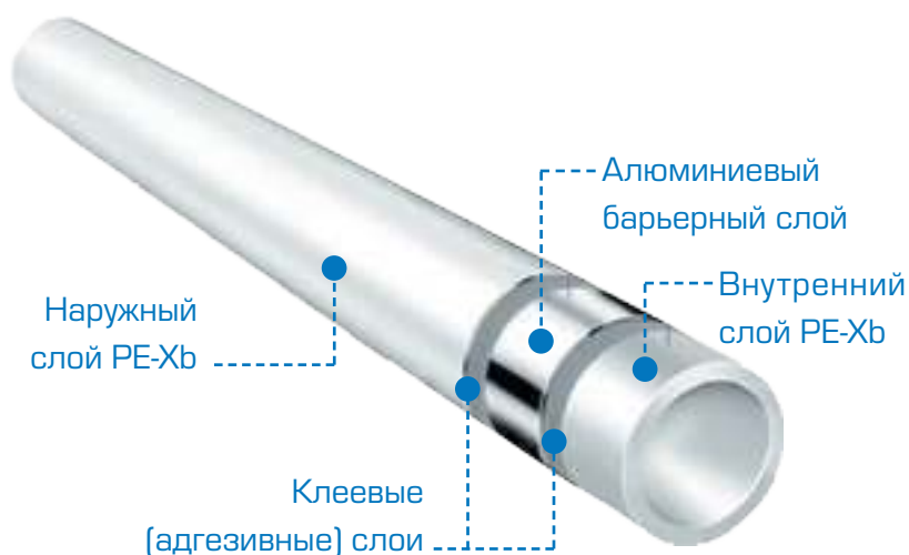
Рис. 5. Пятислойная металлополимерная труба РЕ-Хb/Al/PE-Xb
