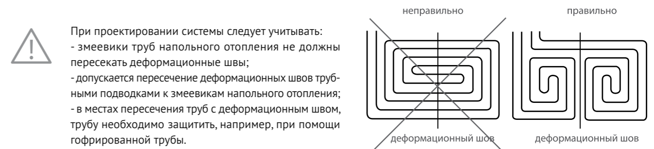
Рисунок 44. Пересечение деформационного шва
