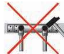
Фасонные части нельзя выправлять молотком
