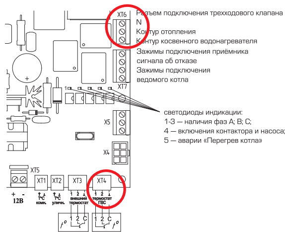
Рис. 13. Схема подключения датчика температуры бойлера
