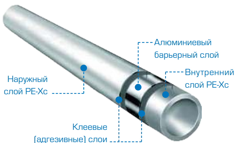
Рис. 2. Пятислойная труба PE-Xc/Al/PE-Xc
