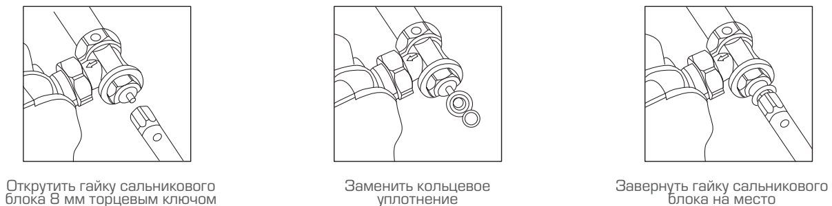
Рис. 21. Замена кольцевого уплотнения штока клапана терморегулятора
