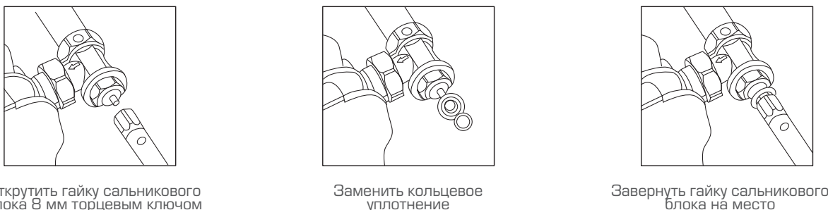
Рис. 21. Замена кольцевого уплотнения штока клапана терморегулятора
