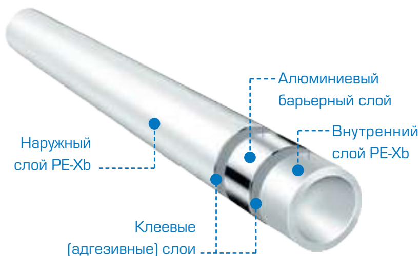
Рис. 5. Пятислойная металлополимерная труба PE-Xb/Al/PE-Xb
