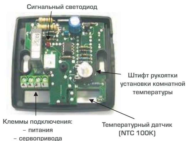
Рис. 12. Устройство электронного термостата для напольного отопления
