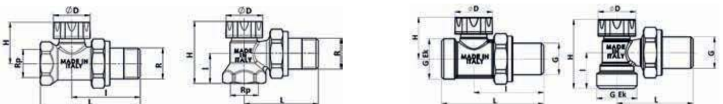
Рис. 31. Устройство запорно-балансировочного клапана типа SVL
