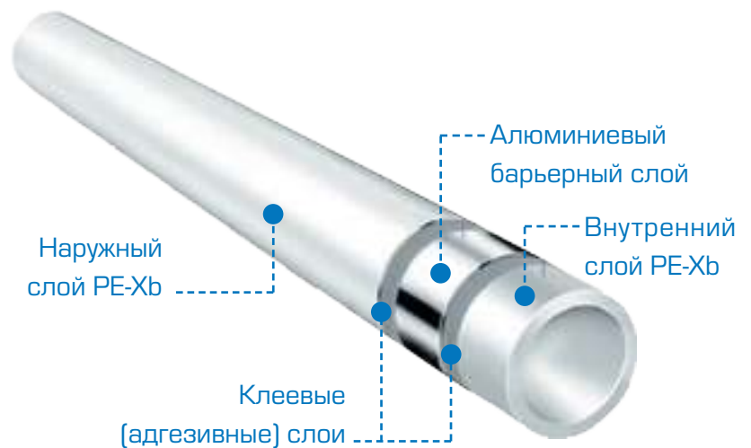
Рис. 5. Пятислойная металлополимерная труба PE-Xb/Al/PE-Xb
