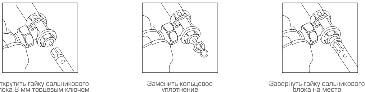
Рис. 21. Замена кольцевого уплотнения штока клапана терморегулятора
