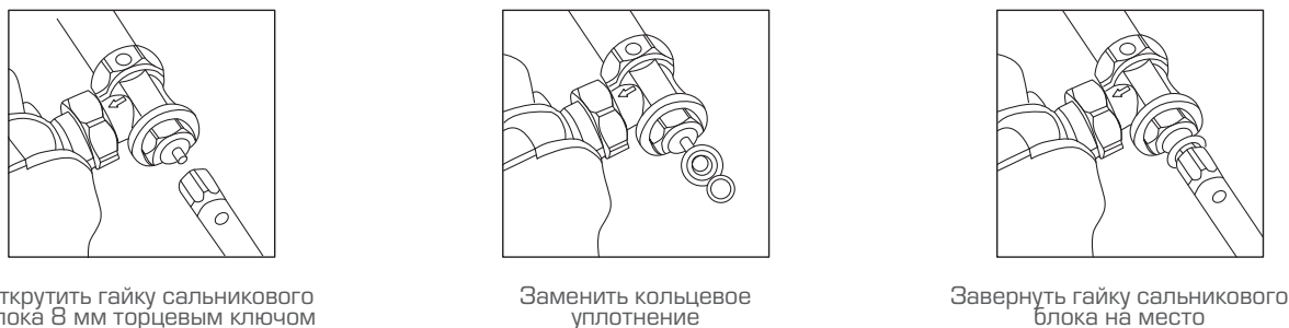
Рис. 21. Замена кольцевого уплотнения штока клапана терморегулятора
