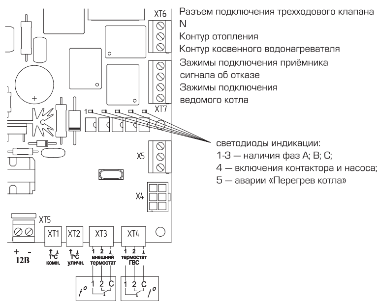
Рис. 5. Расположение разъемов на плате контроллера
