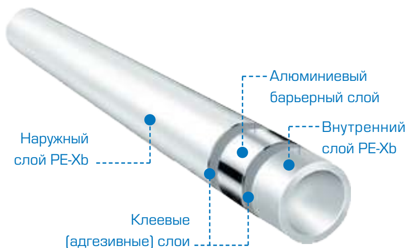
Рис. 5. Пятислойная металлополимерная труба PE-Xb/Al/PE-Xb
