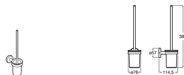
Twin 816715001 Настенный держатель для щетки. Крепление на болты или клей.
