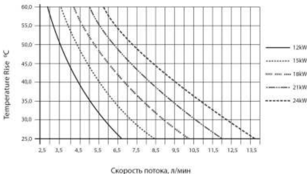
Рис. 4. График производительности системы ГВС
