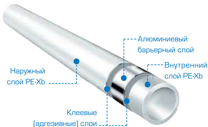
Рис. 5. Пятислойная металлополимерная труба PE-Xb/Al/PE-Xb
