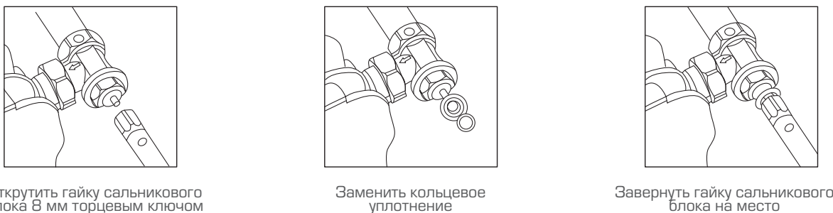
Рис. 21. Замена кольцевого уплотнения штока клапана терморегулятора
