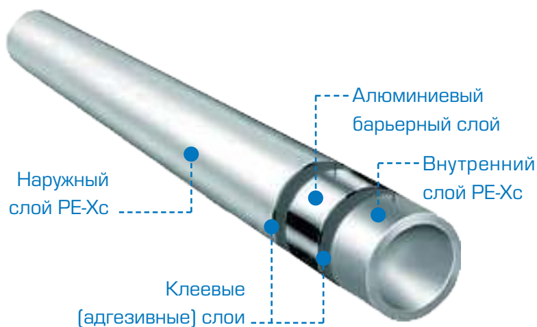
Рис. 2. Пятислойная труба PE-Xc/Al/PE-Xc
