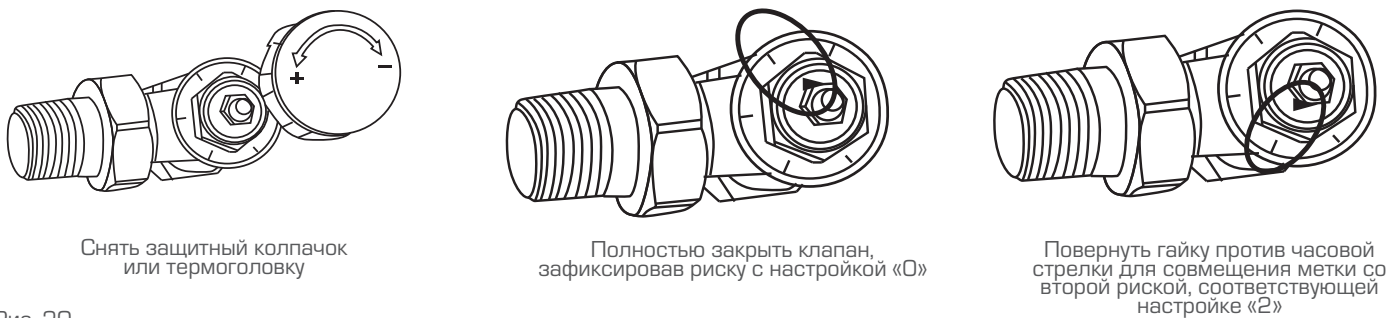
Рис. 20. Пример преднастройки клапана терморегулятора
