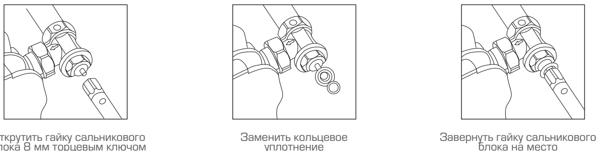
Рис. 21. Замена кольцевого уплотнения штока клапана терморегулятора
