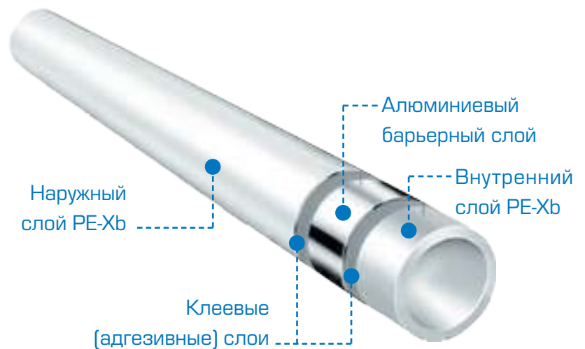
Рис. 5. Пятислойная металлополимерная труба PE-Xb/Al/PE-Xb
