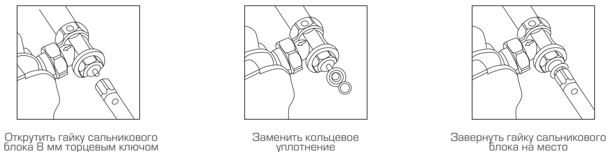
Рис. 21. Замена кольцевого уплотнения штока клапана терморегулятора
