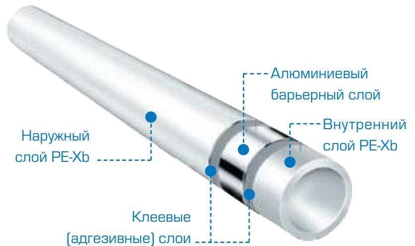
Рис. 5. Пятислойная металлополимерная труба РЕ-Хb/Al/PE-Xb
