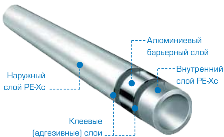
Рис. 2. Пятислойная труба PE-Xc/Al/PE-Xc
