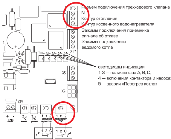
Рис. 13. Схема подключения датчика температуры бойлера
