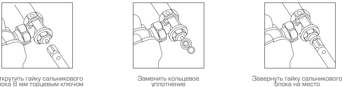
Рис. 21. Замена кольцевого уплотнения штока клапана терморегулятора
