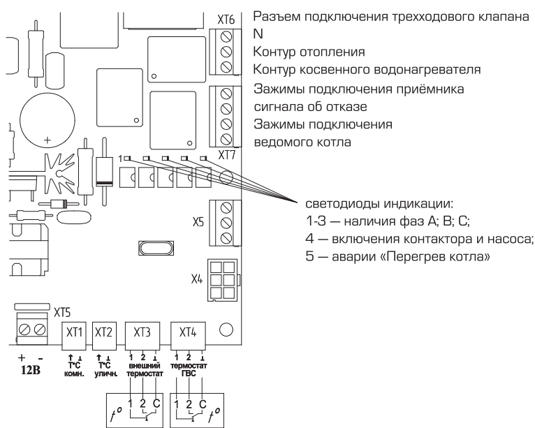
Рис. 5. Расположение разъемов на плате контроллера
