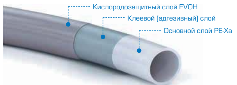
Рис. 1. Трехслойная труба РЕ-Ха/EVONH
