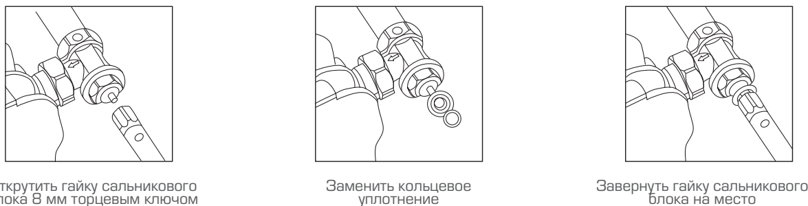
Рис. 21. Замена кольцевого уплотнения штока клапана терморегулятора
