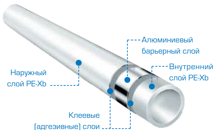
Рис. 5. Пятислойная металлополимерная труба PE-Xb/Al/PE-Xb
