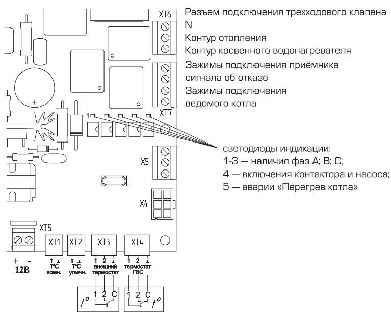
Рис. 5. Расположение разъемов на плате контроллера
