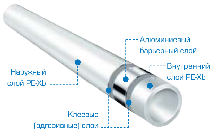
Рис. 5. Пятислойная металлополимерная труба PE-Xb/Al/PE-Xb
