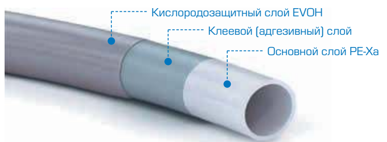
Рис. 1. Трехслойная труба РЕ-Ха/EVOH
