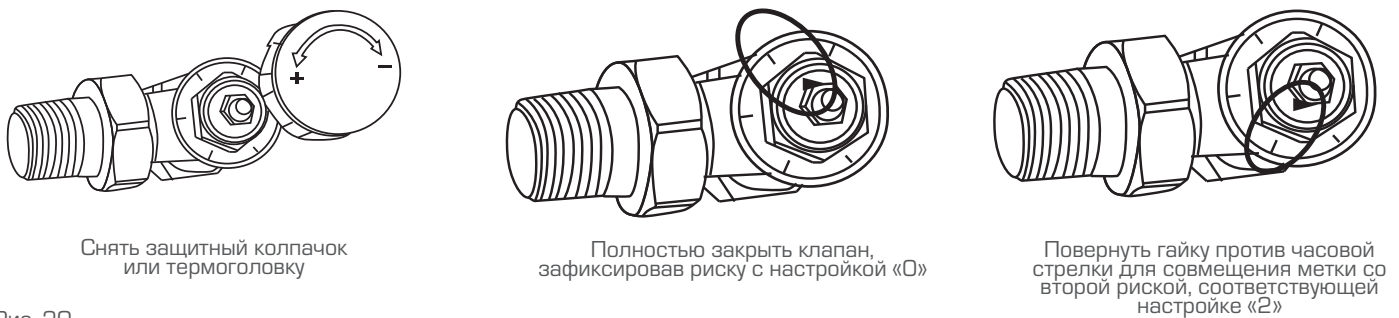
Рис. 20. Пример преднастройки клапана терморегулятора
