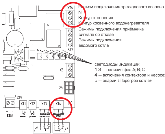
Рис. 13. Схема подключения датчика температуры бойлера
