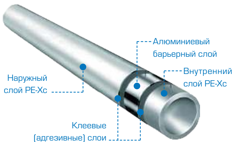
Рис. 2. Пятислойная труба PE-Xc/Al/PE-Xc
