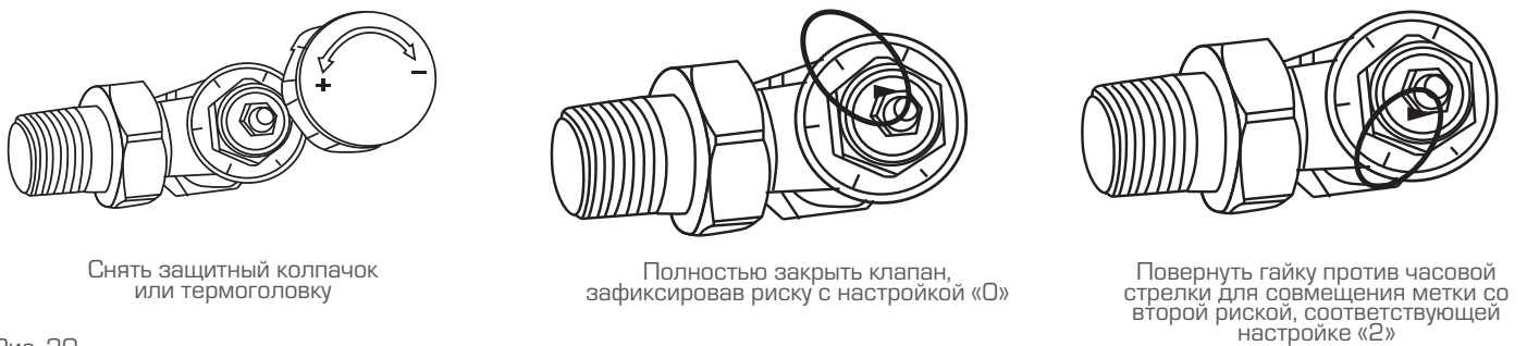
Рис. 20. Пример преднастройки клапана терморегулятора
