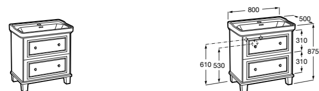
Carmen 857135XXX Модуль для раковины. 3270A0000 Раковина с одним отверстием для смесителя. 3270A0003 Раковина с тремя отверстиями под смеситель.
