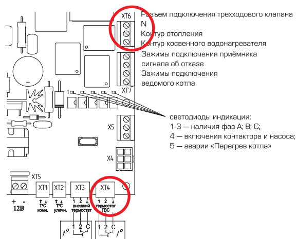
Рис. 13. Схема подключения датчика температуры бойлера
