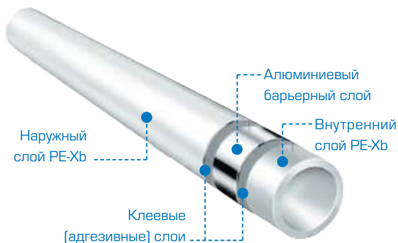
Рис. 5. Пятислойная металлополимерная труба PE-Xb/Al/PE-Xb
